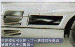
車側壁板可拆開，可一睹排氣喉構造，機構更為全金屬製。
