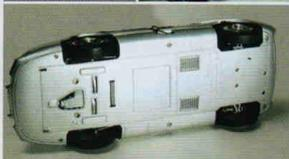
車底幾乎全平，試辦車關係不散拆開，不知內裡包含車架結構與否。
